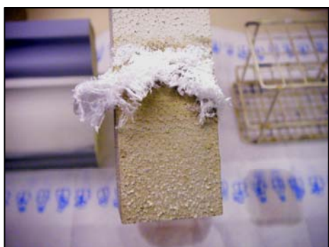
Exzellent vochtregulerende pleister aan het oppervlak niet aangetast ( \text{Na}^2\text{SO}^4 \times 10\text{H}^2\text{O} ) door de zeer speciale poriëngeometrie
