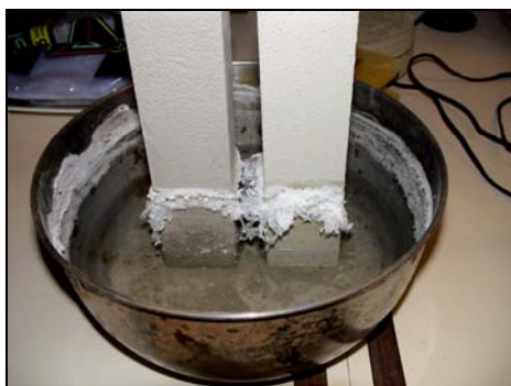
Saneringspleister WTA (links) Exzellent pleister (rechts)
