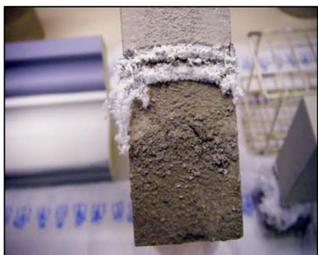
Saneringspleister WTA aan het oppervlak aangetast ( \text{Na}^2\text{SO}^4 \times 10\text{H}^2\text{O} )
