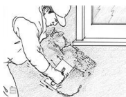
en in grondmortel inbedden. Deze extra weefselstroken ook over klossen t.b.v. montage doeleinden.
