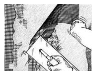
Het weefsel overlappend (100 mm) inbedden. Er ontstaat een z.g. wafel-effect.
